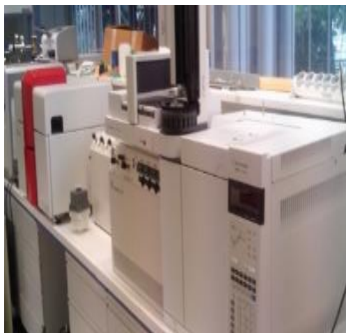
Εικόνα 1: Το σύστημα μέτρησης EA-IRMS του εργαστήριου φυτικής Παραγωγής
